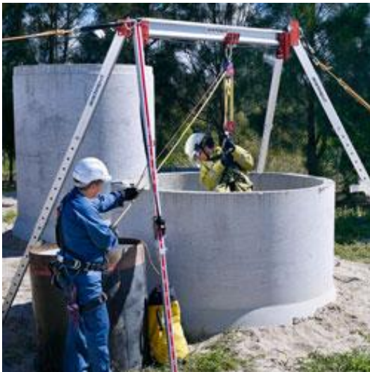
Fig. 5. Ancoraggio mobile a cui fissare mezzi anticaduta o per il recupero persone. Lunghezze standard 2 m, 3 m e 4 m. Progettato per operare con più persone. PRODUTTORE arachnipod http://www.arachnipod.com/
